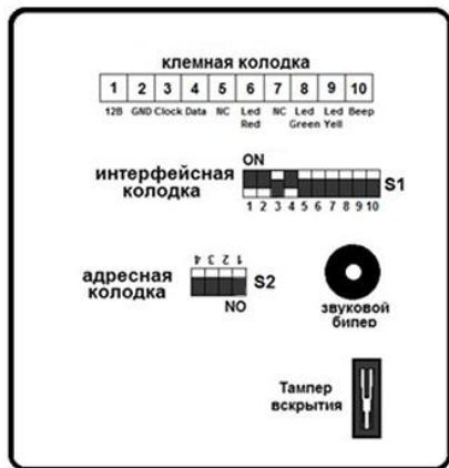
Рисунок №9. Вид считывателя с тыльной стороны
